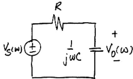
$$H(\omega) = \frac{V_o(\omega)}{V_s(\omega)} = \frac{1}{1 + j\omega CR}$$
