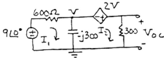
$$\text{KVL loop } I_1: 600I_1 - j300(I_1 - I_2) = 9$$
