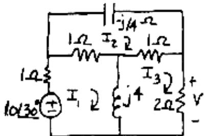
$$\begin{bmatrix} (2+j4) & -1 & -j4 \\ -1 & (2+1/j4) & -1 \\ -j4 & -1 & (3+j4) \end{bmatrix} \begin{bmatrix} I_1 \\ I_2 \\ I_3 \end{bmatrix} = \begin{bmatrix} 10\angle 30^\circ \\ 0 \\ 0 \end{bmatrix}$$
