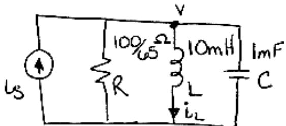
$$\text{KCL : } i_s = \frac{v}{R} + i_L + C \frac{dv}{dt}$$
