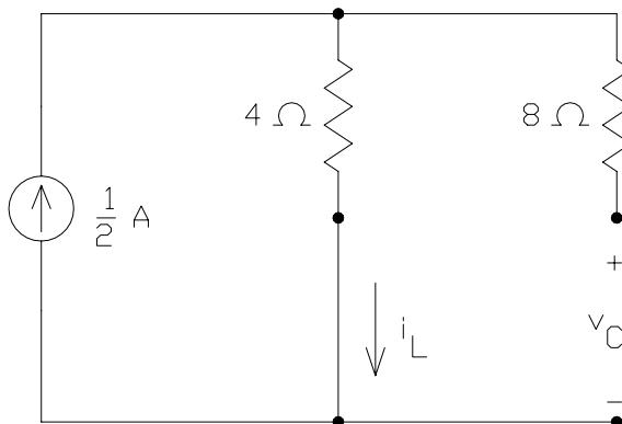
so  $i_L(0+) = i_L(0-) = 0.5\text{ A}$  and  $v_C(0+) = v_C(0-) = 2\text{ V}$ .
