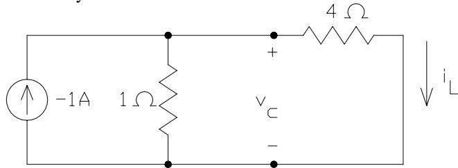
so  $i_L(0+) = i_L(0-) = -0.2 \text{ A}$  and  $v_C(0+) = v_C(0-) = -0.8 \text{ V}$ .
