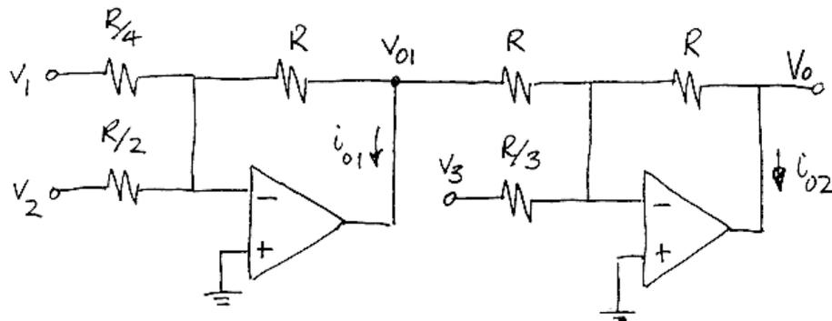
$$v_{01} = -(4v_1 + 2v_2); \quad v_0 = -(v_{01} + 3v_3) = 4v_1 + 2v_2 - 3v_3$$
