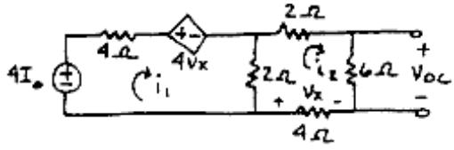
$$\text{KVL at } i_1: -4I_0 + 4i_1 - 4v_x + 2(i_1 - i_2) = 0 \\ \Rightarrow 6i_1 - 2i_2 + 4v_x - 4I_0 = 0 \quad (1)$$
