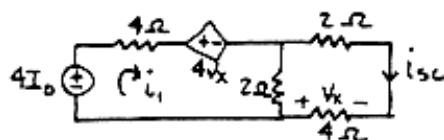
$$\text{KVL at } i_1: -4I_0 + 4i_1 + 4v_x + 2(i_1 - i_{sc}) = 0 \\ \Rightarrow 6i_1 - 2i_{sc} + 4v_x - 4I_0 = 0 \quad (1)$$
