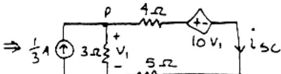
from KVL a:  $-v_1 + 4i_{sc} + 10v_1 + 5i_{sc} = 0$
