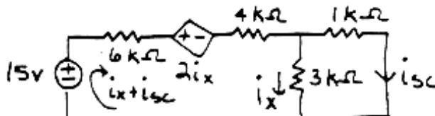
$$\text{KVL } \alpha i_x + i_{sc}: -15 + 2i_x + 10(i_x + i_{sc}) + 3i_x = 0$$
