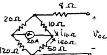
$$v_{50\Omega} = 50(17 - 20) = -150 \text{ V} \Rightarrow v_{oc} = v_{10\Omega} + v_{50\Omega} = 170 - 150 = 20 \text{ V}$$
