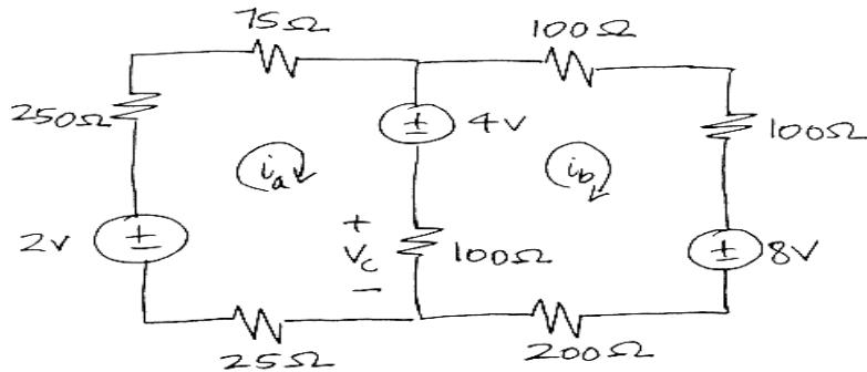
$$\text{loop 1} \quad 25 i_a - 2 + 250 i_a + 75 i_a + 4 + 100(i_a - i_b) = 0$$
