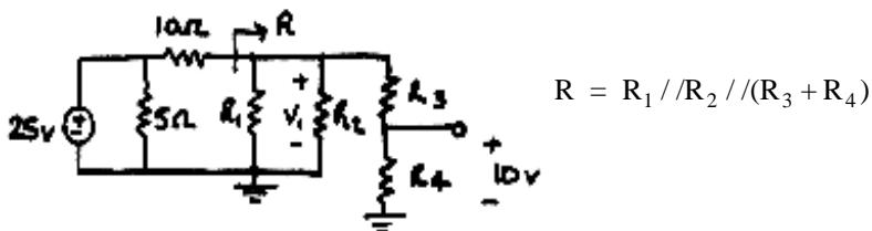
$$R = R_1 / R_2 / / (R_3 + R_4)$$
