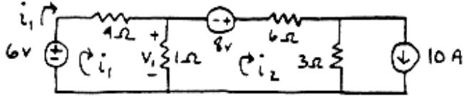
$$\text{KVL mesh } i_1 : -6 + 4i_1 + (i_1 - i_2) = 0 \Rightarrow -6 + 5i_1 - i_2 = 0 \quad (1)$$
