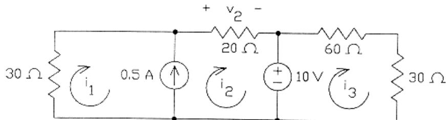
$$\text{loop1} \quad i_1 - i_2 = -0.5 \Rightarrow i_1 = i_2 - 0.5$$
