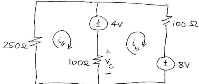
$$\text{loop a} \quad 250 i_a + 4 + 100(i_a - i_b) = 0$$
